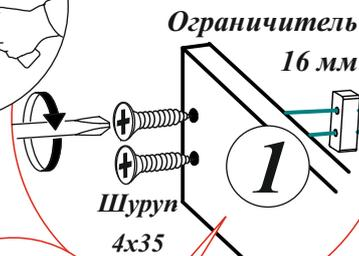
Регулировка створки по глубине
