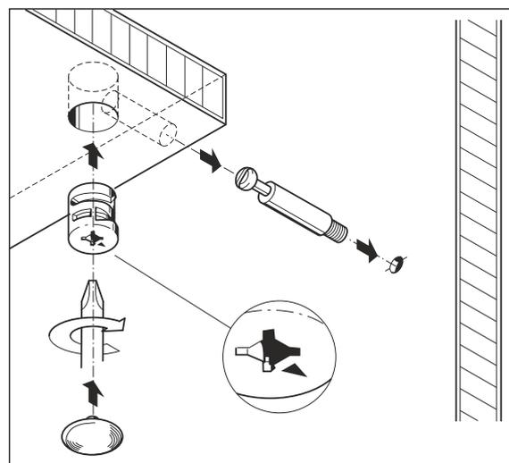
1. Сборка производится горизонтально, тыльной стороной вниз. Предварительно на боковины 1 и 2 установить направляющие 300 мм с помощью евровинтов 6,3\*10,5 мм.
