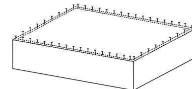
Начните сборку с каркаса. Проверьте перпендикулярность и параллельность щитов каркаса и зафиксируйте с помощью задней стенки из ДВП, как указано на рисунке, не нарушая диагонали.
