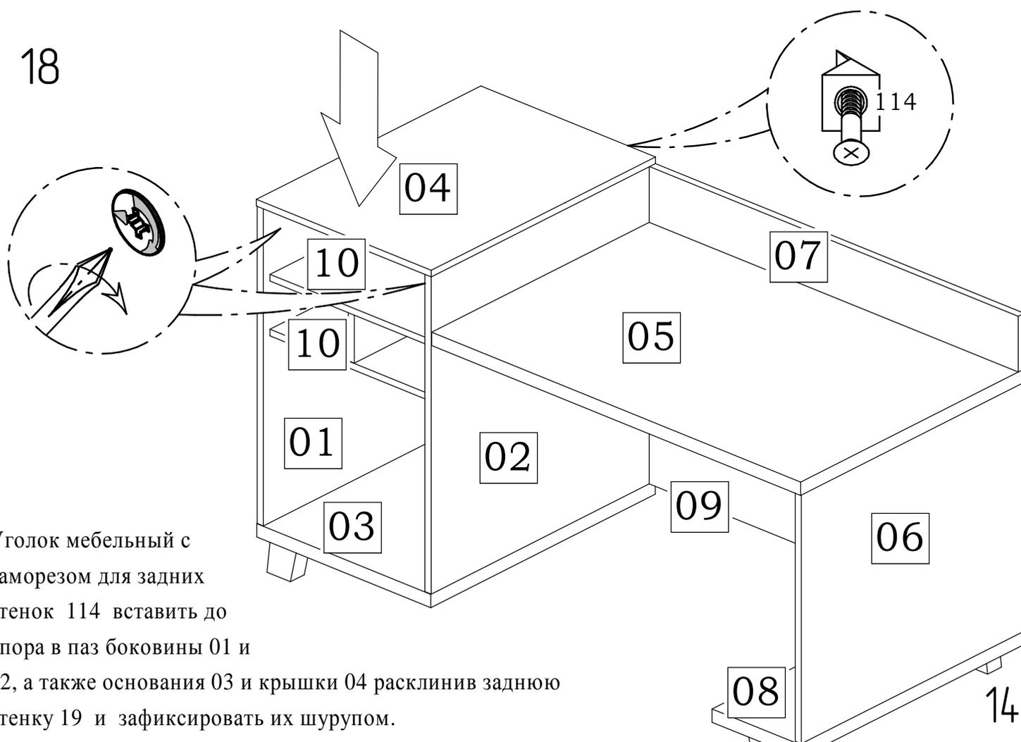
Уголок мебельный с саморезом для задних стенок 114 вставить до упора в паз боковины 01 и 02, а также основания 03 и крышки 04 расклинив заднюю стенку 19 и зафиксировать их шурупом.
